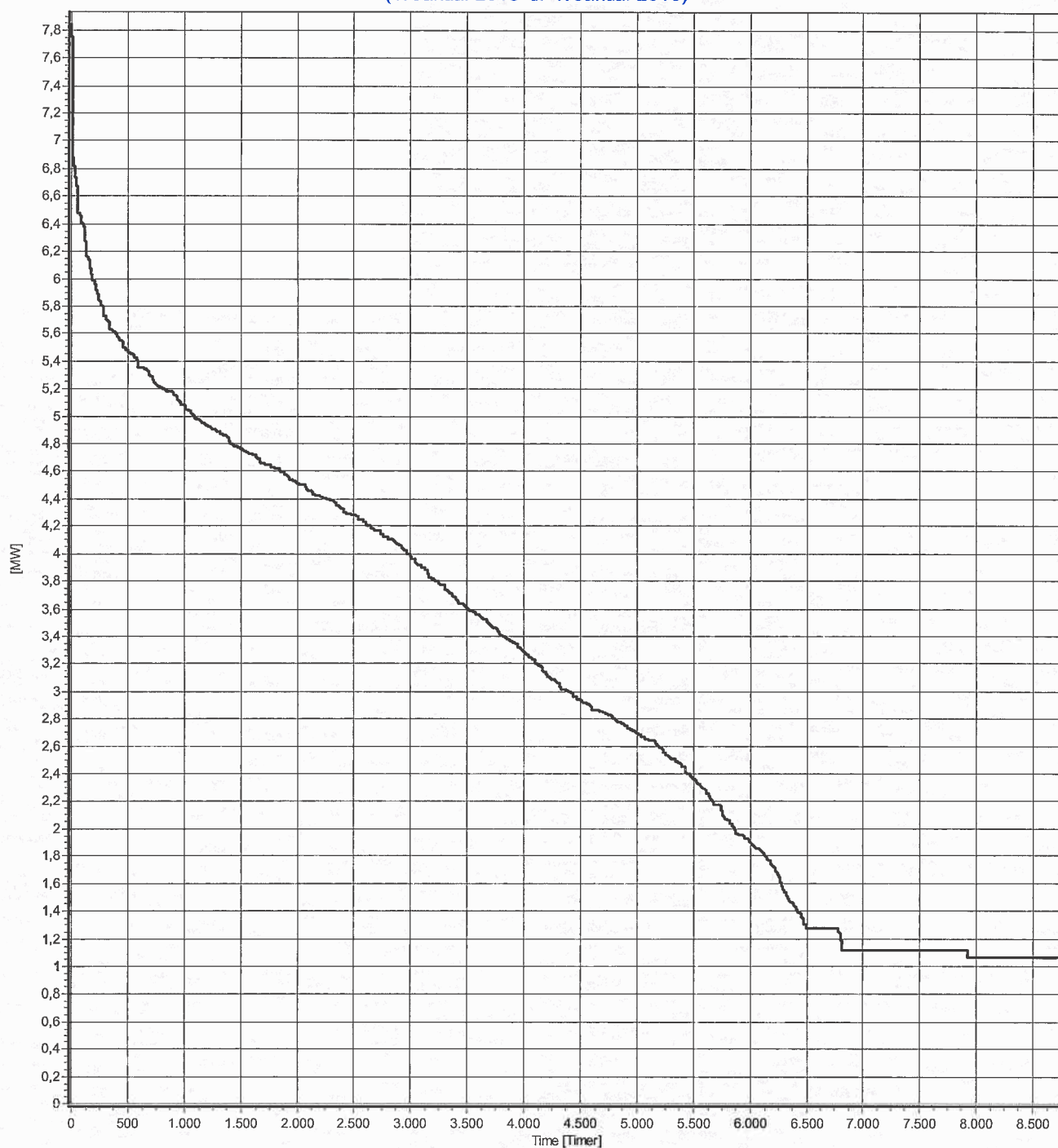
Varighedskurve for varmebehov (1. Januar 2015 til 1. Januar 2016)
