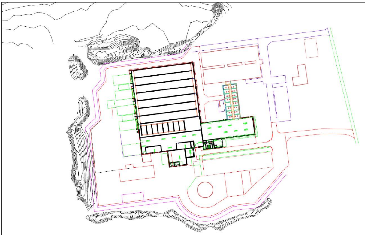
Ansøgers indsendte kotekort, som angiver terrænets koter efter etablering af biovoldene. De nye koter går fra cirka kote 81-86,5 og er markeret med sorte linje.
