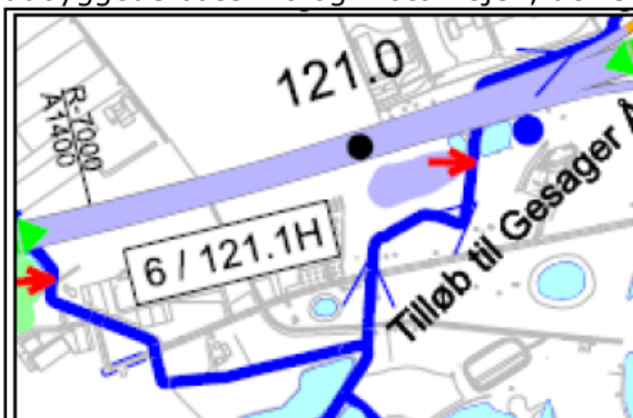
Figur 5. Oversigtskort, der viser opland til Bassin 6. Bassin 6, vist med lyslilla farvemarker, skal rense og forsinke vej- og overfladevandsafstrømning fra et opland på 4,63 ha og et reduceret areal på i alt 2,89 red. ha, hvoraf rampe SØ og SV udgør 0,10 red. ha; og E45 Østjyske motorvej udgør 2,79 red. ha. Oplandet der afleder vejvand til bassin 6 er vist med lyslilla farve. Bassin 6 og hele oplandet til bassinet er beliggende i område, der er udpeget som 'Område med særlige drikkevandsinteresser'. Bassin 6 er beliggende, hvor der er indvindingsopland til alment vandværk, og området er registreret som nitratfølsomt og særlig følsomt indvindingsopland. Blå streg viser åbent vandløb. Udløb, vist med rød pil, vil som hidtil ske i vandløbet Gesager Å øst for motorvej E45 Østjyske Motorvej. Udløb fra eksisterende bassin nedlægges, og nyt udløb fra bassin 6 er øst herfor.
