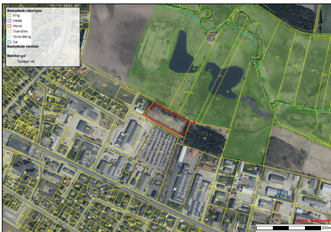
Figur 10. 2022-luftfoto af området, hvor regnvandsbassinet og udledningsspunkt placeres. Den røde polygon angiver placering af regnvandsbassin. Det røde punkt angiver placering af udledningsspunkt. De gule linjer angiver matrikelskel. Beskyttede naturtyper er vist med signaturforklaring i øverste venstre hjørne. Målestok er angivet i nederste højre hjørne. Baggrundskort © SDFE, 25.08.2022/ WMS-tjeneste, Ortofoto forår 2022, matrikelskel og beskyttede naturtyper. Indeholder data, som benyttes i henhold til vilkår for brug af danske offentlige data.
