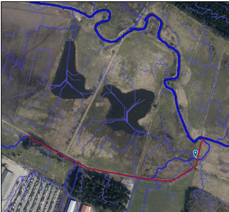
Figur 8. Udsnit fra SCALGO med illustration af strømningsveje samt en markering af overløbspunkt. Blå punktmarkering viser overløbspunkt fra grøften. Rød illustrerer grøften. Orto: 2020.
