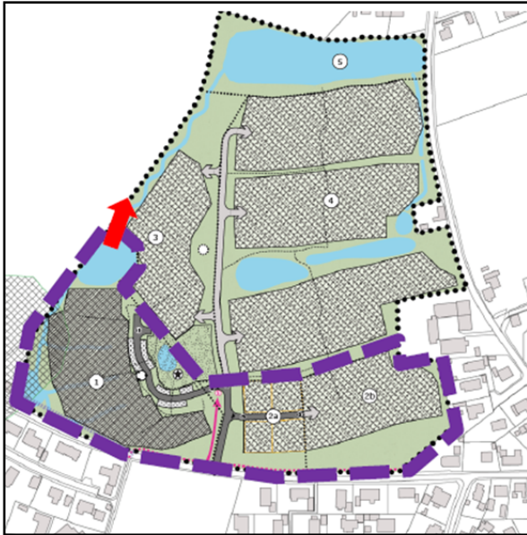
Figur 1 , viser, med stiplet lilla streg, afgrænsningen af området, hvor der planlægges privat fællesanlæg til håndtering af tag-, vej- og overfladevand. Med rød pil er vist, hvor det private fællesanlæg får udledning i vandløb på en rørlagt strækning. Illustrationen er udarbejdet af ATRA arkitekter a/s og er fra ansøgningsmaterialet. Den blå markering med rød pil angiver placeringen af rense- og forsinkelsesbassin, hvor den røde pil viser det omtrentlige udløbspunkt, i rørlagt strækning af det offentlige vandløb 'Rørledning B'.
