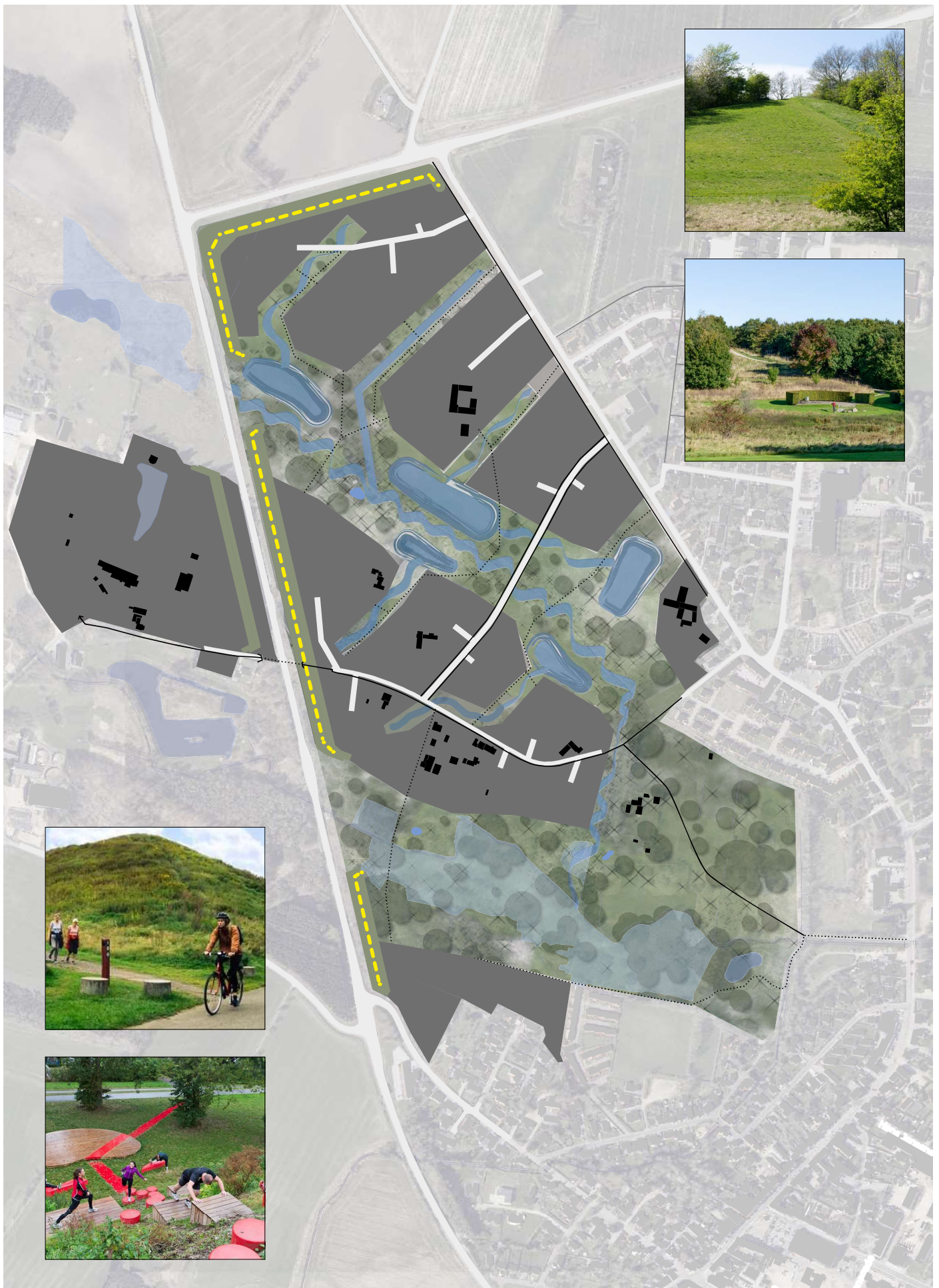
Støjafskærmningen er på kortet markeret med en gul prikket streg. Billederne viser hvordan en støjvold ikke bare behøves at være en aflag kæmpe jordbunke, men kan formes som bakker i forskellig højde og bruges rekreativt. Det nedeste billede er et projekt "En voldsom omvej" i Solrød støttet af LOA.
